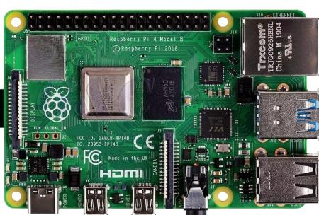
La Raspberry Pi 4 Model B integra el SoC Broadcom BCM2711 con CPU ARM Cortex-A72 de 64 bits, ofrece opciones de 1-8 GB LPDDR4, conectividad de 2 USB 3.0 y 2 USB 2.0, Gigabit Ethernet, Wi-Fi ac/Bluetooth 5.0, doble micro-HDMI (hasta 4K 60 fps) y un puerto MIPI CSI-2 para cámaras, lo que habilita pipelines de captura de baja latencia y procesamiento 100 % en el borde (Raspberry Pi, 2024).
